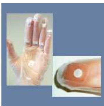
Figure 38 : Dosimètres thermoluminescents placés au niveau des mains
